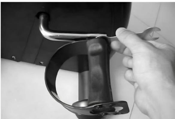
3. Fixez chaque pédale en la tournant. La pédale droite se fixe en tournant dans le sens horaire. La pédale gauche se fixe en tournant dans le sens antihoraire.
