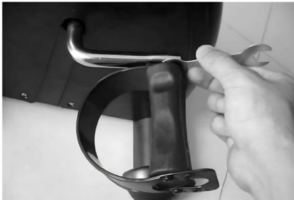
3. Fissa ciascun pedale ruotandolo. Il pedale destro viene fissato ruotando in senso orario. Il pedale sinistro viene fissato ruotando in senso antiorario
